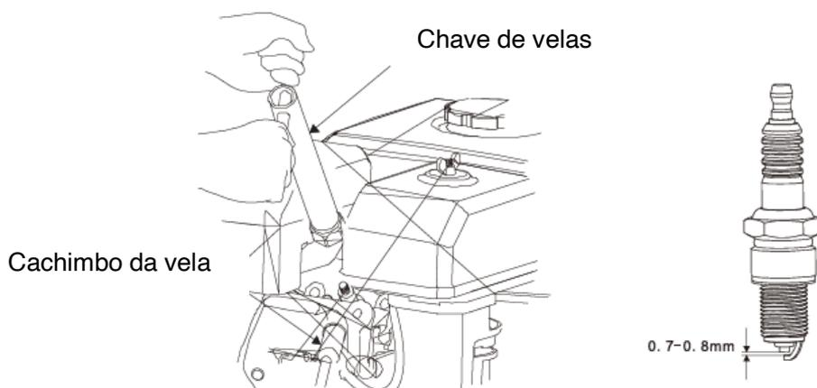
4. Verifique se a junta da vela de ignição está em boas condições. Para evitar danificar a rosca da cabeça do cilindro, enrosque a vela de ignição manualmente com cuidado.
